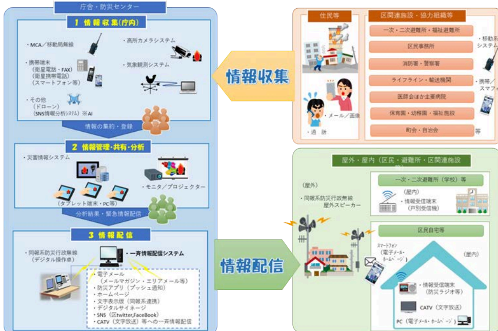
図Ⅱ-5 災害時等における情報の収集から配信のイメージ図
