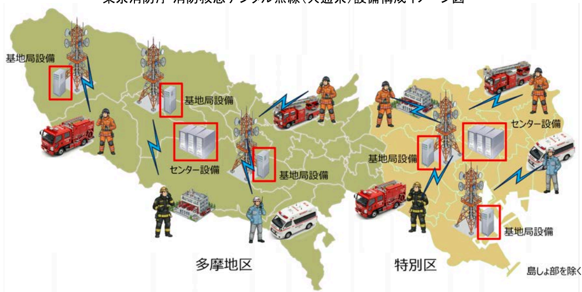
東京消防庁 消防救急デジタル無線(共通系)設備構成イメージ図
