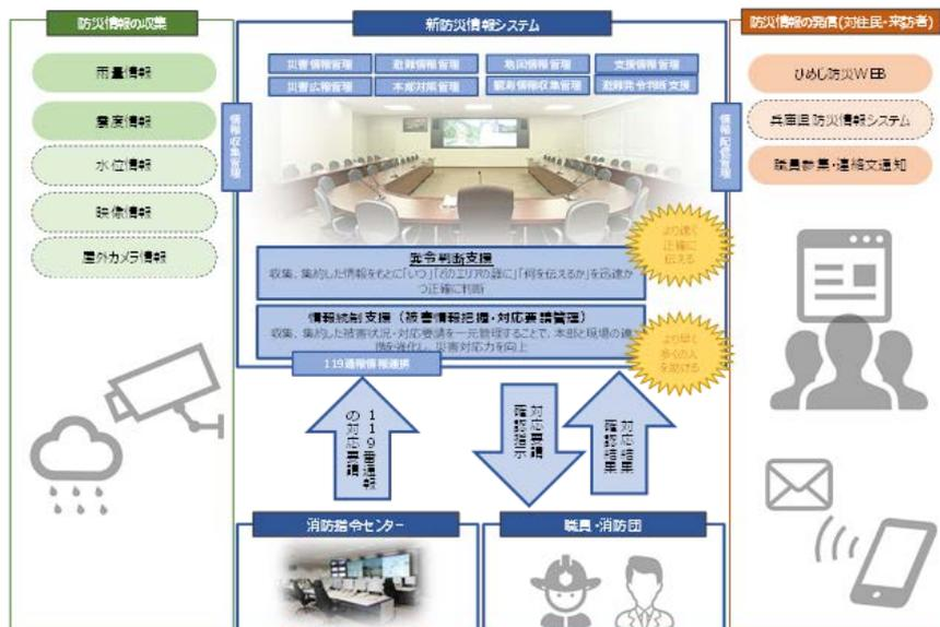
震度計情報や河川の水位情報、屋外カメラ等からの映像情報を防災センターの防災情報システムで集中管理し、災害に係わるような一定の閾値に達すると同システムを通じて関係者にアラートを発する機能を有しています。
