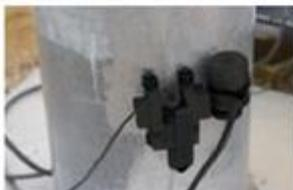
自走式超音波センサーが鋼管に取り付き、全周をスクリーニングします。
